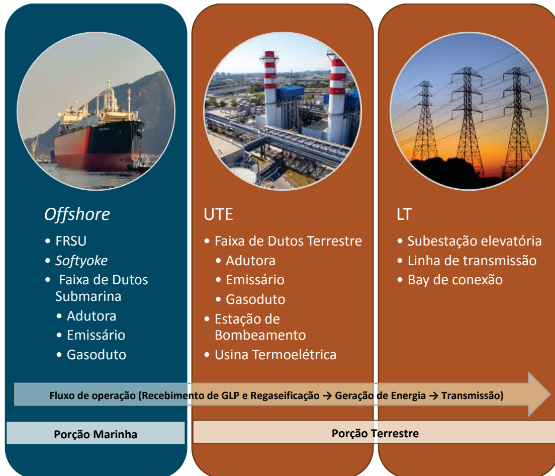
Figura 2: Diagrama das estruturas que compõem as unidades do Complexo Termoeletrico Porto de Sergipe I
